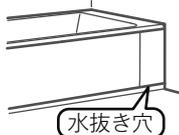
……▶ 追いだき循環金具取り付け部から水漏れしている可能性があります。 ……▶ 追いだき循環金具取り付け部の修理が必要です。
