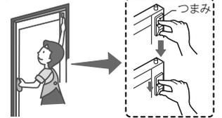
③つまみを下げたままドア上部をバスルーム内側に少し倒し、ドアのピボットをドア枠の穴から取り外してください。
