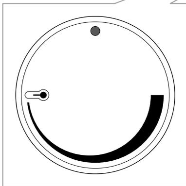
ヒーター本体の右側についているダイヤルは温度設定に使用します。時計回りに回していただき、お好みの温度に設定してください。
