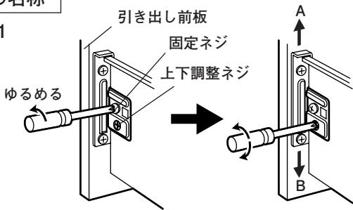
※上下調整ネジは左右両方の引き出しレールについています。
