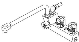
4 水抜栓を外し、配管内の水が抜けたら元通りにする。
