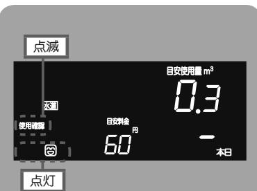
**12** (台所リモコンは ) で過去 7 日間の水道使用量、目安料金の実績を表示します。
