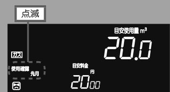
5 再度
