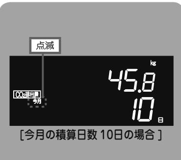
**9** 再度 の上げるスイッチ押すと、先月の CO<sub>2</sub> 排出量の実績を表示します。
