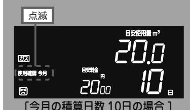
4 再度
