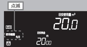
5 再度
