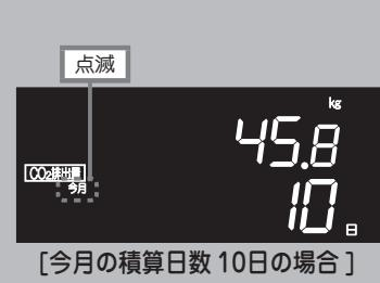
**9** 再度
