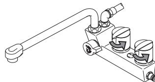
④ 給水元栓の水抜き栓を外し、給水・給湯配管の水抜き栓を開け、約5分程度そのままにして水が出なくなるまで待つ。配管内の水が抜けたら全ての水抜き栓と給水栓、給湯栓を閉める。
