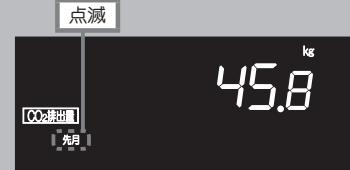
**10** 再度
