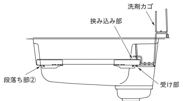
また、どこでも水切りを下に配置し、どこでもまな板の裏面を上にして洗剤カゴの挟み込み部に差し込むようにしてどこでも水切りの上に重ねることで、硬い野菜などを切るのにもご使用頂けます。
