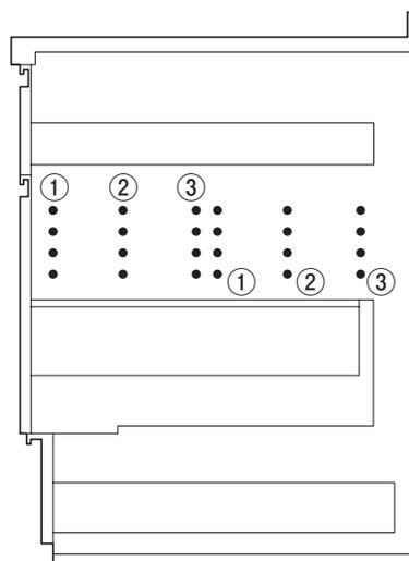
どこでもパレットの後方の溝に棚受けを挿入したあと、どこでもパレット前方の溝に棚受けが確実に入らない場合や、どこでもパレット前方が棚受けから外れてしまう場合は、前後の棚受け穴の組み合わせが誤っている可能性があります。
