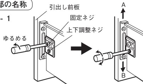
※上下調整ネジは左右両方の引出しレールについています。
