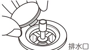
③排水口フタを外して軸部を左廻し(反時計廻し)に回転させてコイル状ワイヤーの圧縮を解いてください。
