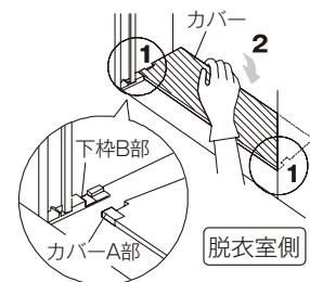
②レールをカバーの隙間に差し込み取り付ける。
