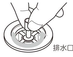
④排水栓を作動させ押しボタン部が上がつたことを確認してください。
