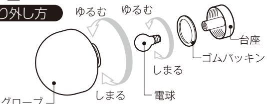
取付の際は、ゴムパッキンを忘れずに入れてください。しめすぎ・ゆるめすぎのないよう気を付けてください。方向のあるグローブの場合、水平になるように取り付けてください。
