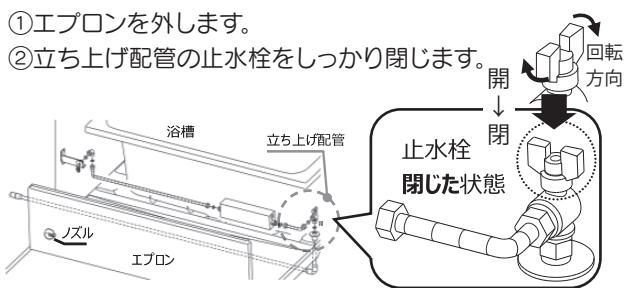
③立ち上げ配管に接続している、フレキホースのナット部を工具でゆるめて外します。中から、フィルターと、パッキンが出てきます。紛失しない様、タオルなどの上へ載せて作業を行ってください。
