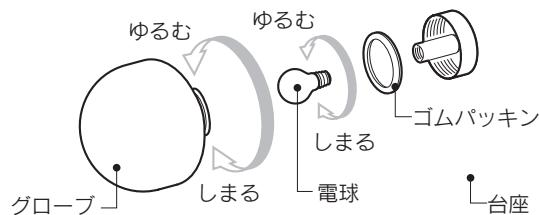
取付の際は、ゴムパッキンを忘れずに入れてください。しめすぎ・ゆるめすぎのないよう気を付けてください。方向のあるグローブの場合は、水平になるように取り付けてください。
