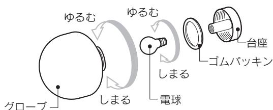
取付の際は、ゴムパッキンを忘れずに入れてください。しめすぎ・ゆるめすぎのないよう気を付けてください。方向のあるグローブの場合、水平になるように取り付けてください。
