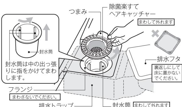
お掃除が終わったら、封水筒やヘアキャッチャー、排水フタを正しく取り付けてください。その後、トラップ内に封水をためるために洗面器1杯くらいの水を流してください。
