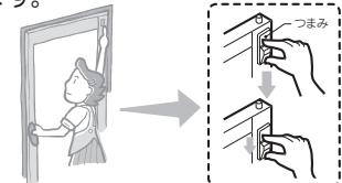
③つまみを下げたままドア上部をバスルーム内側に少し倒し、ドアのピボットをドア枠の穴から取り外してください。
