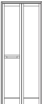
ガラリがないタイプは、ドア枠上部に脱衣室から空気を取り込むための換気口が内蔵されています。
