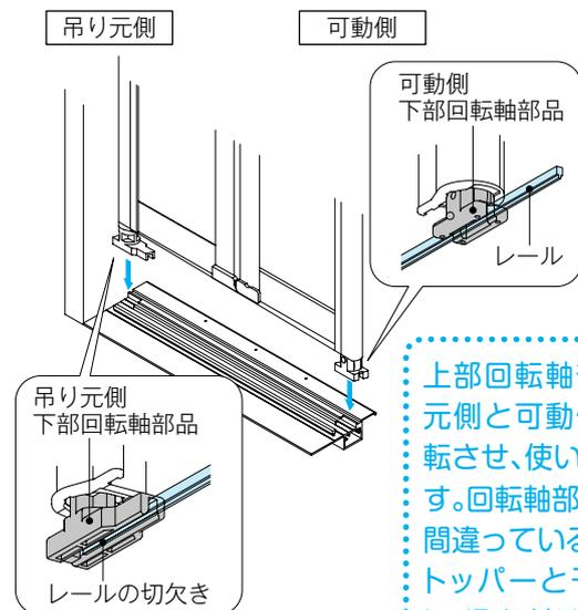
上部回転軸部品は吊り元側と可動側を90°回転させ、使い分けをします。回転軸部品の向きが間違っていると、上枠ストッパーと干渉して正しく取り付けできません。
