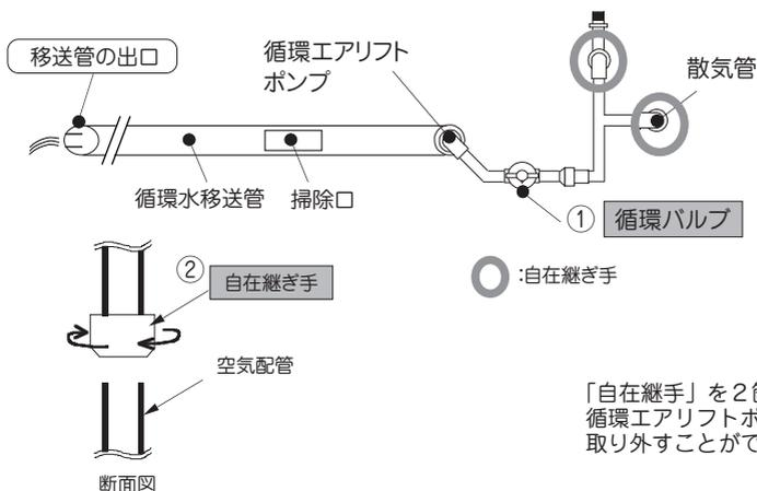
「自在継手」を2箇所緩めると、循環エアリフトポンプの空気管を取り外すことができます。
