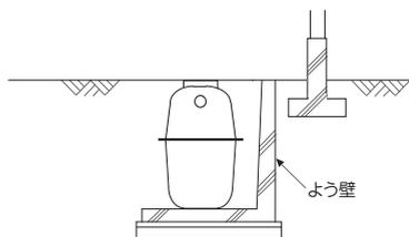
●よう壁の仕様は、よう壁にかかる荷重の大きさや荷重の方向によって異なりますので、構造計算を十分行って施工してください。
