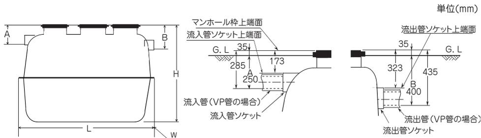
⚠ ※構造図（認定シート等）に表示されている浄化槽の全高、流入管底および流出管底は、マンホール枠の高さを含んでいません。
